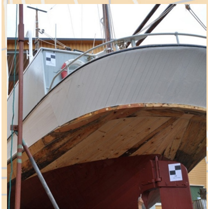
Plasseringen av «targets» må tenkes nøye gjennom. For hver scanneposisjon må scanneren gjenkjenne minst tre slike for å kunne kalkulere sin nye posisjon i forhold til den forrige. Dette er spesielt viktig å planlegge når en skal runde hjørner, flytte scanneren opp på dekk og inn i fartøyet. Dersom dette gjøres ordentlig, blir det mindre etterarbeid med registreringa ettersom scanneren fortløpende kan plassere punktskyene fra de ulike scanneposisjonene i forhold til hverandre. Mister scanneren disse referansene må punktskyene sys sammen manuelt i programvaren, noe som er meget tidkrevende.
