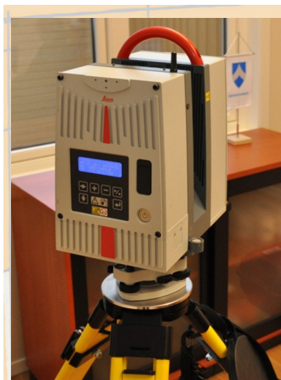
3d-laserscanneren som ble benyttet. Her er den satt opp for testkjøring innendørs mens vi ventet på oppholdsvær.
