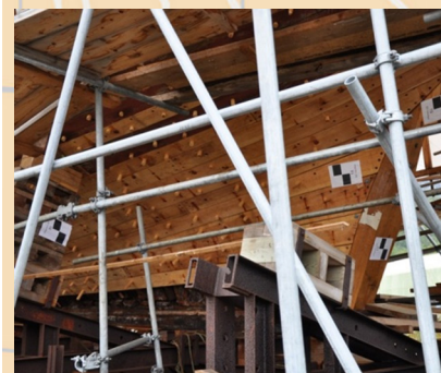
Forholdene rundt Fugløy var ikke optimale for scanning pga. stillaser og nagler i skroget.
