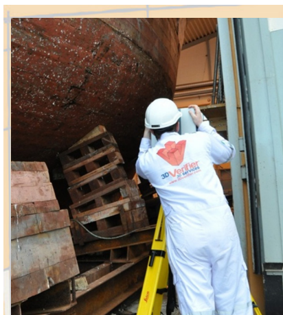
Enda sjekker at scanneren kan se referansepunktene (targets) rundt om ved å kikke gjennom scanner-speilet.
