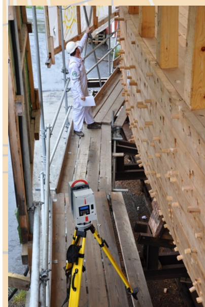
Vi var spente på om det lot seg gjøre å scanne Fuglø ettersom fartøyet var omgitt av stillaser og reisverk. Naglene lager også «støy».
