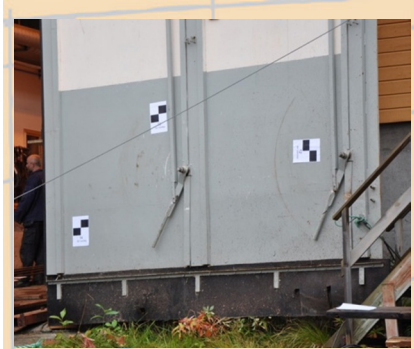
«Targets» plassert på døra til slipp-hallen ved Nordnorsk Fartøyvern-senter. Ved hjelp av disse kan scanneren finne hvor den er i forhold til forrige scanneposisjon.
