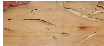
Trestykke fra et fartøy med boreganger fra pælemark. Foto: HFS
