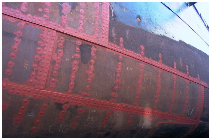
En klinket hudplate i skipsskrog. Bildet viser hvordan plata er festet til nærliggende hudplater og spant ved klinking (foto: Bredalsholmen Dokk og Fartøyvernssenter/BDF).
