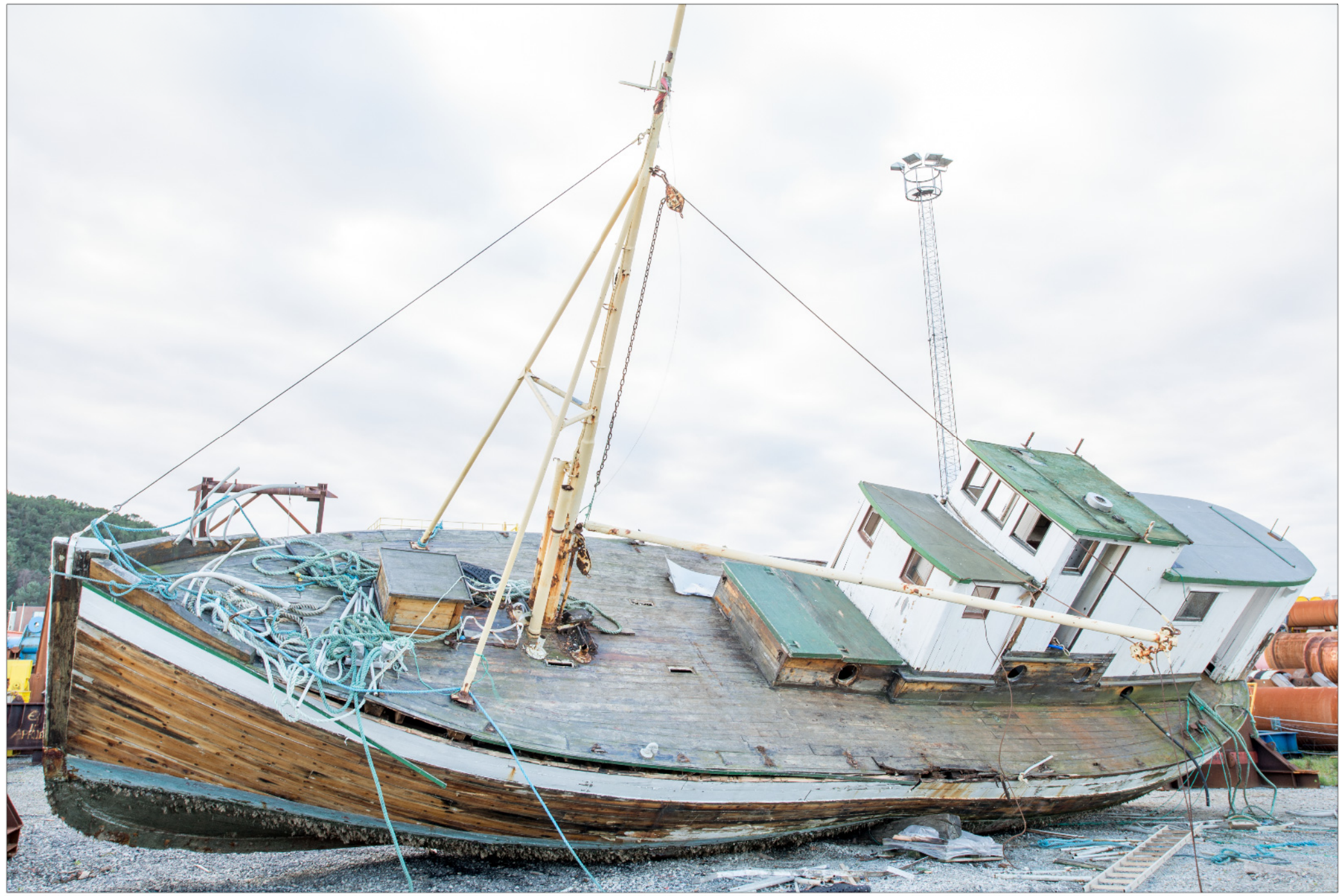
Skroget ble dokumentert ved hjelp av fotogrammetri den 14.11.2014. Argus var da løftet på land ved hjelp av krane, og satt på ei nokså grov sville omlag midt under. Skroget lå mot babord hvor skutesiden var trykket inn. Skrog og dekk var adskilt på babord da det hadde revnet langs skandekket fra midtskibs frem til svinerygg.
